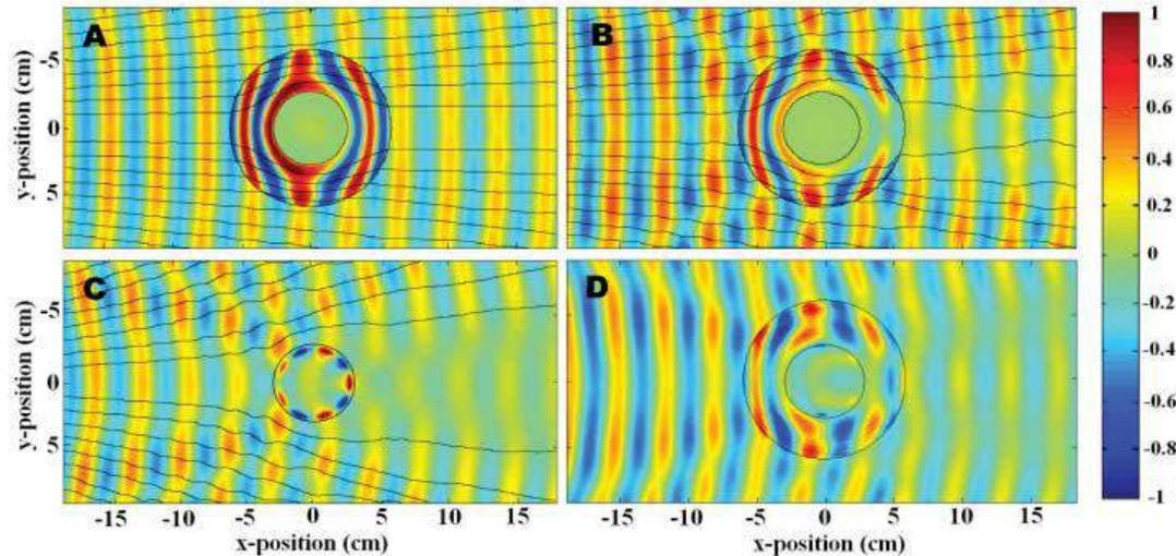
図14: クローキングの電場分布のシミュレーション(A),(B)とクロークなしの実測値(C)およびクロークで囲んだ場合の実測値。(A)は理想的な場合、(B)は損失を取り入れた現実的なパラメタによる計算。
